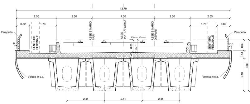
SEZIONE TIPO IN ASSE APPOGGIO - Scala 1:50
