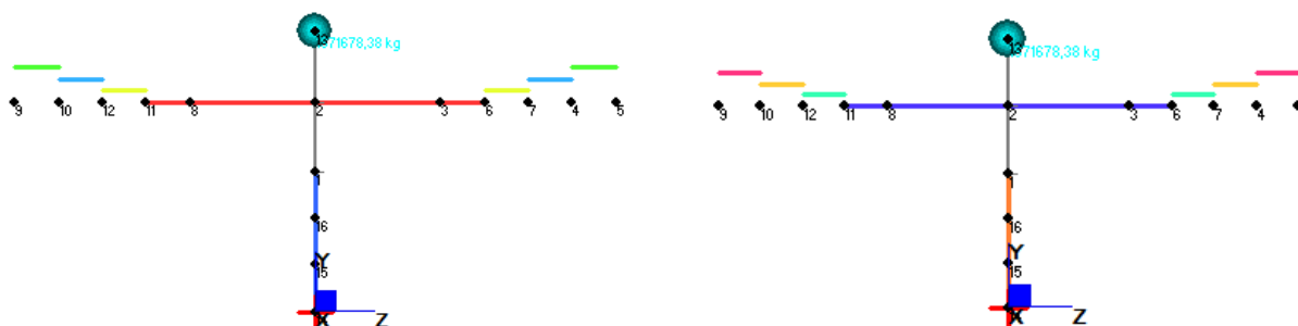
Figura 48 - Modello pila 6.00m - Pila e pila fessurata
