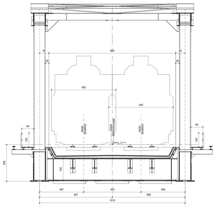
SEZIONE TIPO IN CAMPATA-Scala 1:50
