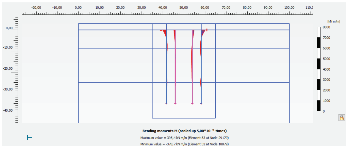
Figura 34 - N, V, M - Sez. trasv. - Comb. 4 – SLE – RA
