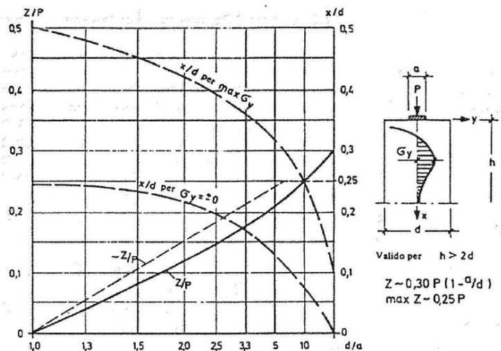
Fig. 3.8: Grandezza della forza di fenditura risultante Z, riferita al carico P, distanza della tensione massima trasversale  $\max \sigma_y$  e distanza del punto con  $\sigma_y = 0$  dal bordo caricato in lastre con  $h > 2d$  (40)
