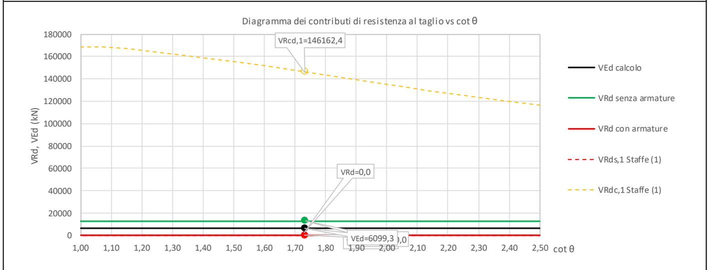
Non si è reso necessario l'inserimento di armatura trasversale per questa sezione.
