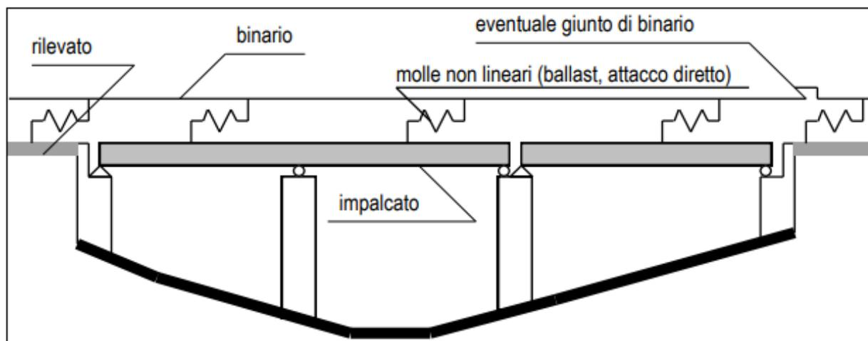
Fig. 2.5.1.4.5.3-1 - Schema di modello strutturale per valutare l'interazione.
