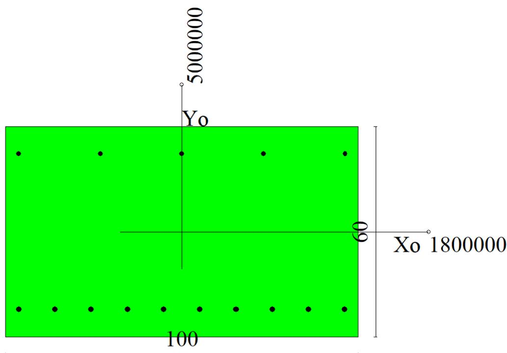
Figura 38 – Sezione trasversale muro paraghiaia e relativa armatura
