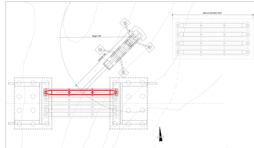
PARTICOLARE MOVIMENTAZIONE TRAVI IMPALCATO - PROSPETTO Scala 1:200
