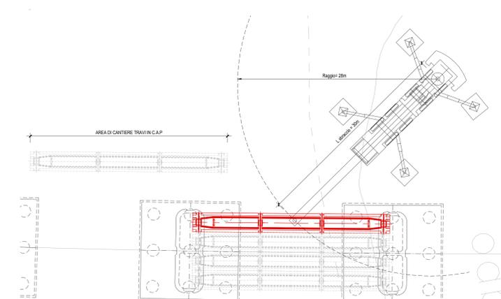
**PARTICOLARE MOVIMENTAZIONE TRAVI IMPALCATO - PROSPETTO** Scala 1:200
