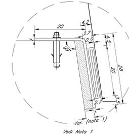
Nota 1: lo spessore della maglia di tipo EMACO tra la piastra in acciaio del cuscinetto in neoprene e il ritegno trasversale deve essere collorata in funzione della posizione effettiva delle travi nel rispetto delle prescrizioni del punto 2.5.2.1.5.5 del Manuale di Progettazione ITALFERR (RFI DIC SI FS MA IFS 001 A)
