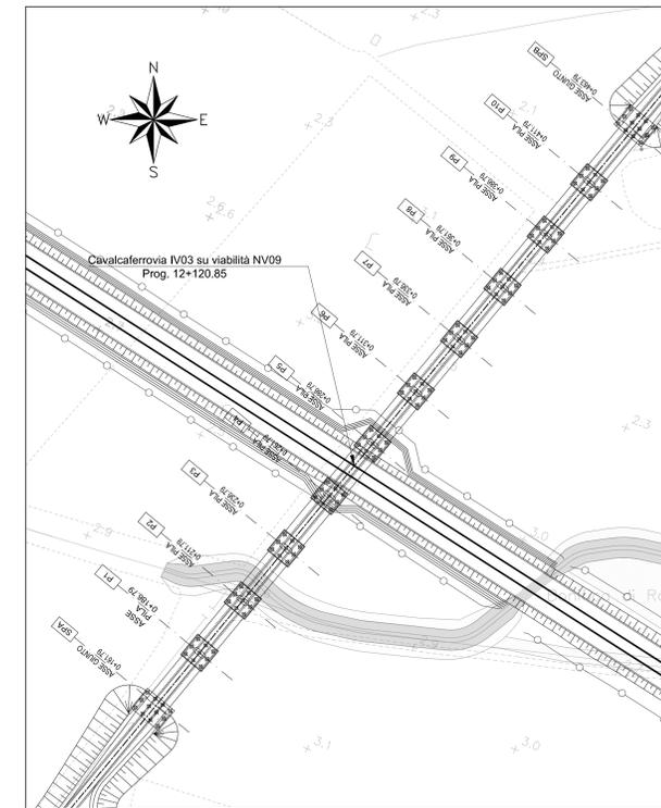
N.B.: IN FASE DI PROGETTO COSTRUTTIVO, L'APPALTATORE, DI CONCERTO CON IL PREFABBRICATORE, TERRA OPPORTUNAMENTE CONTO DELLE TOLLERANZE DI MONTAGGIO E COSTRUTTIVE DELLE TRAVI IN C.A.P. E DETERMINERA' NEL DETTAGLIO LA LARGHEZZA SUPERIORE DELLE STESS E RISPETTO ALL'INTERASSE.
