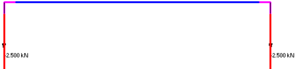
Figura 27 – Modello trasversale muri – Azioni permanenti non strutturali
