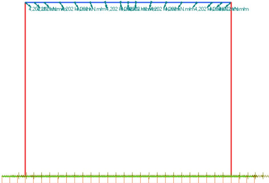
*Figura 22 – Modello trasversale muri – Momento da azione da traffico centrifuga*
