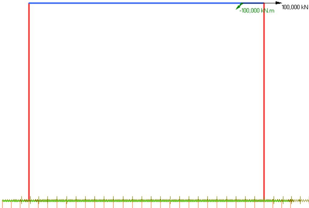
Figura 40 - Modello trasversale muri – Azione eccezionale urto veicolare
