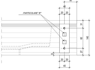
N.B.: IN FASE DI PROGETTO COSTRUTTIVO L'APPALTATORE, DI CONCERTO CON IL FRIEFABBRICATORE "TERRA" OPPIORTUNAMENTE CONTO DELLE TOLLERANZE DI MONTAGGIO E COSTRUTTIVE DELLE TRAVI IN C.A.P. E DETERMINERÀ NEL DETTAGLIO LA LARGHEZZA SUPERIORE DELLE STESSE RISPETTO ALL'INTERASSE.
