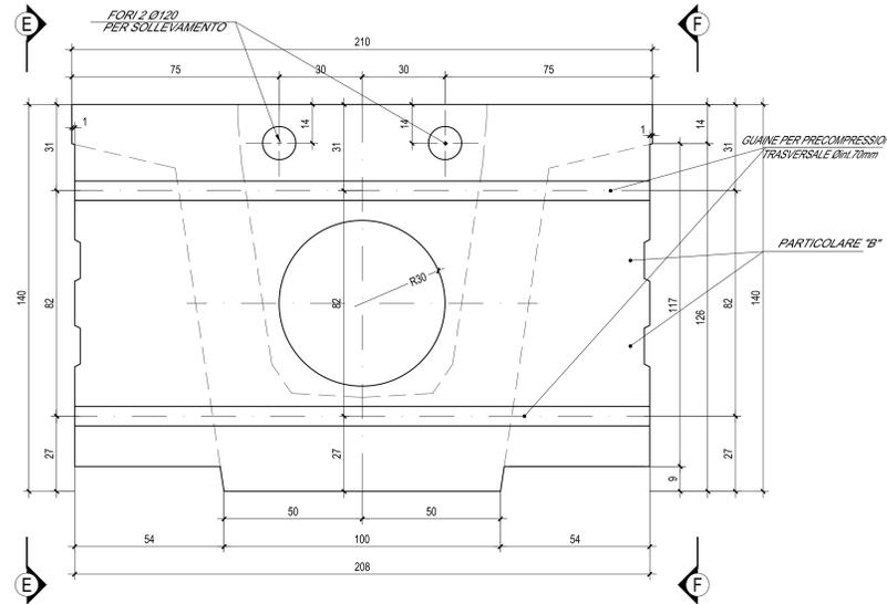
SEZIONE LONGITUDINALE IN ASSE TRAVE CENTRALE - Scala 1:25
