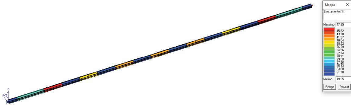
Figura 13.175 –Mappa cromatica dei valori di sfruttamento degli elementi strutturali espressi, in percentuale, come il maggiore dei tre rapporti tra le tensioni massime (resistenza, stabilità, svergolamento) e quelle limite di progetto
