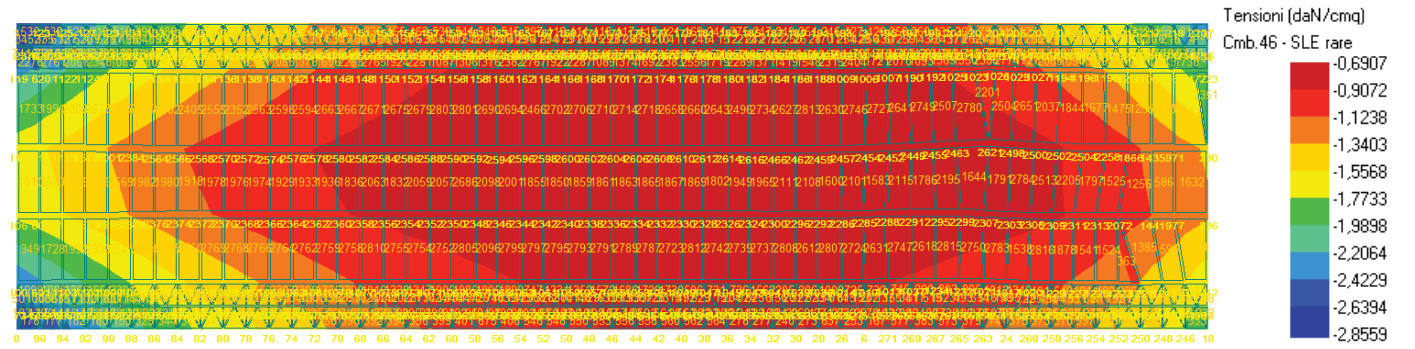
Figura 13.6 – Mappa delle tensioni relativa alla combinazione SLE rara che ne massimizza il valore
