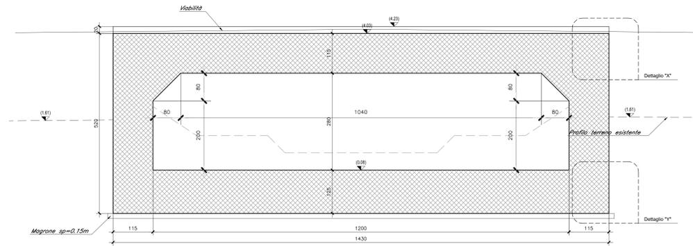
SEZIONE TIPO MURO AD U-Scala 1:50
