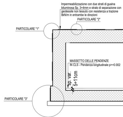
SCHEMA DI POSA IMPERMEABILIZZAZIONE - Scala 1:20
