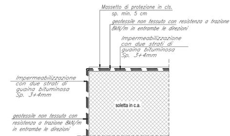
SCHEMA DI POSA IMPERMEABILIZZAZIONE - Scala 1:20
