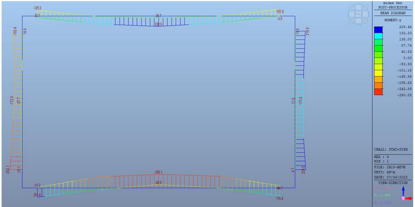
Inviluppo diagrammi del momento flettente – SLU statico e sismico
