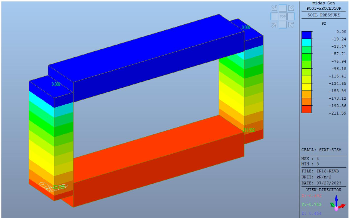
La sollecitazione risulta pari a **0.212 Mpa** e minore di quella resistente derivante dalla verifica in CND pari a **0.251 Mpa**.
