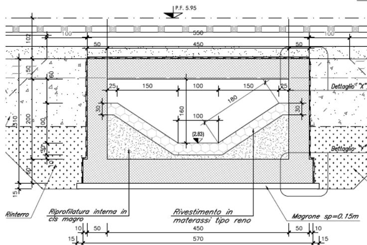
Fig. 2 – Sezione trasversale dell'opera
