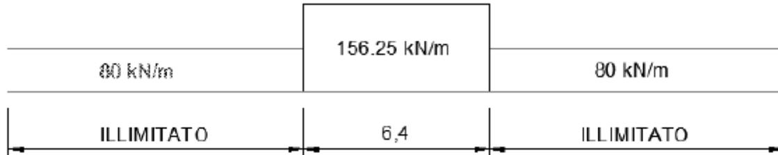
Mentre la larghezza di diffusione in direzione trasversale avviene secondo la seguente procedura: la diffusione dei carichi attraverso Ballast avviene con pendenza 1:4, attraverso il ricoprimento con angolo di attrito mentre, nella soletta in cls con pendenza 1:1.
