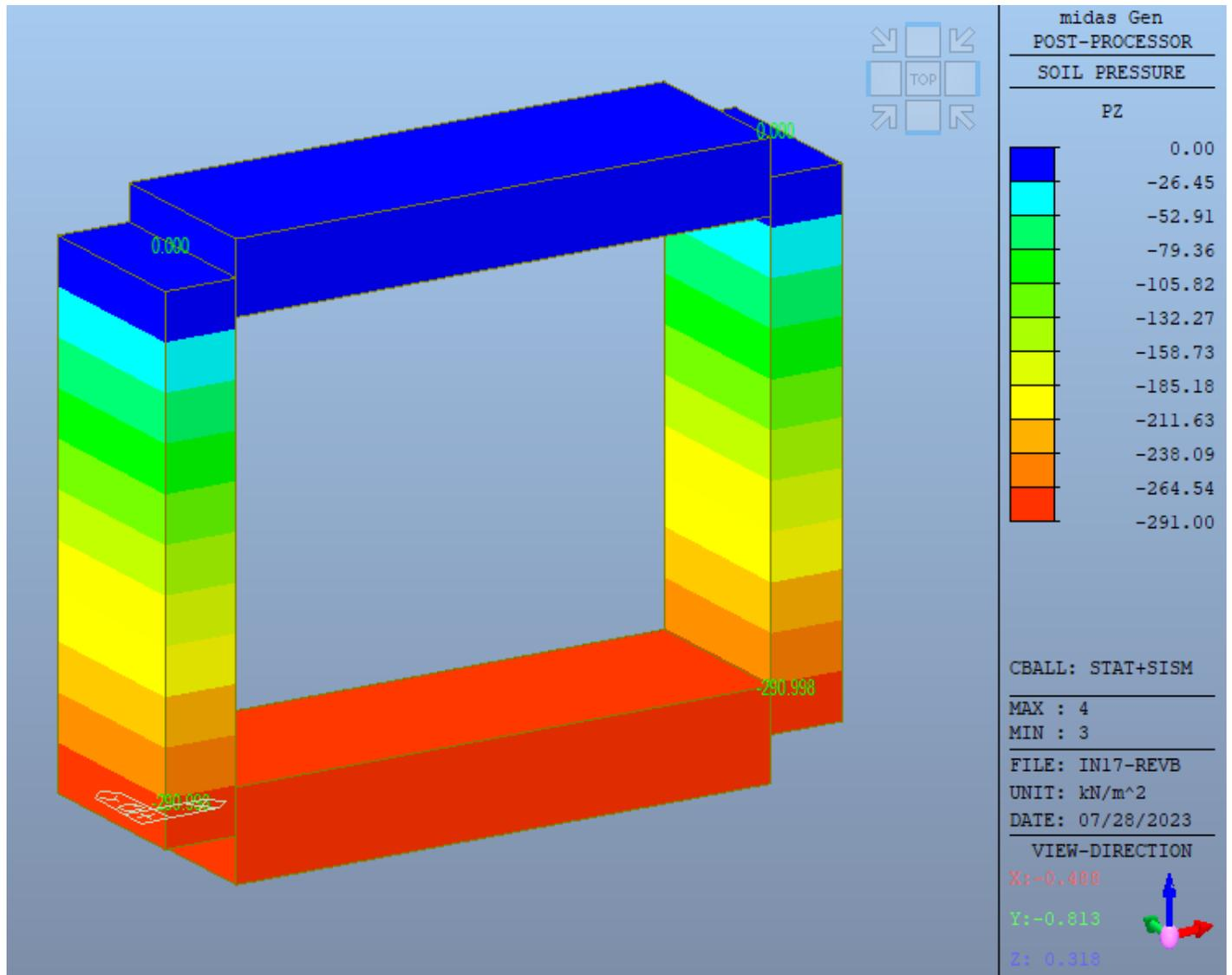
La sollecitazione risulta pari a **0.291 Mpa** e minore di quella resistente derivante dalla verifica in CND pari a **0.299 Mpa**.
