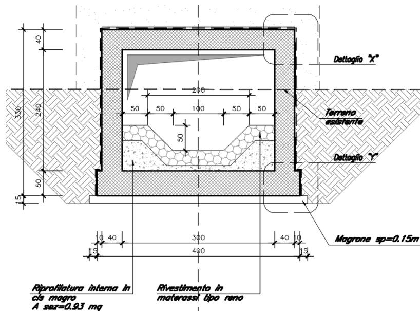
*Fig. 2 – Sezione trasversale tipo*
