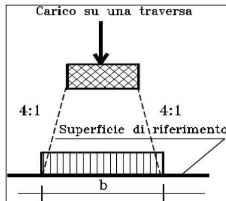
I carichi effettivi di progetto vanno tuttavia valutati portando in conto anche gli eventuali effetti dinamici; attraverso la determinazioni dei coefficienti  $\Phi 2$  o  $\Phi 3$  e del coefficiente di adattamento ( $\alpha$ ), secondo quanto specificato a riguardo nel documento RFIDTCINCPOSPIFS001A.
