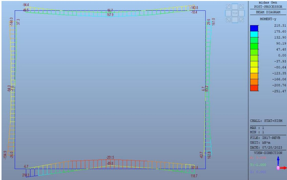
*Inviluppo diagrammi del momento flettente – SLU statico e sismico*
