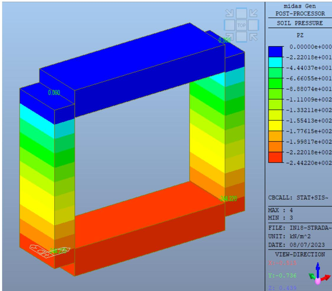
La sollecitazione risulta pari a **0.244 Mpa** e minore di quella resistente derivante dalla verifica in CD pari a **0.255 Mpa**.
