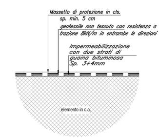
SCHEMA DI POSA IMPERMEABILIZZAZIONE - Scala 1:20
