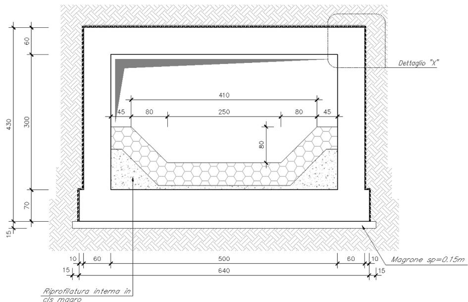
**Fig. 2 – Sezione trasversale tipo**
