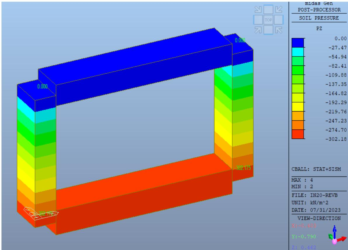
La sollecitazione risulta pari a **0.302 Mpa** e minore di quella resistente derivante dalla verifica in CND pari a **0.483 Mpa**.
