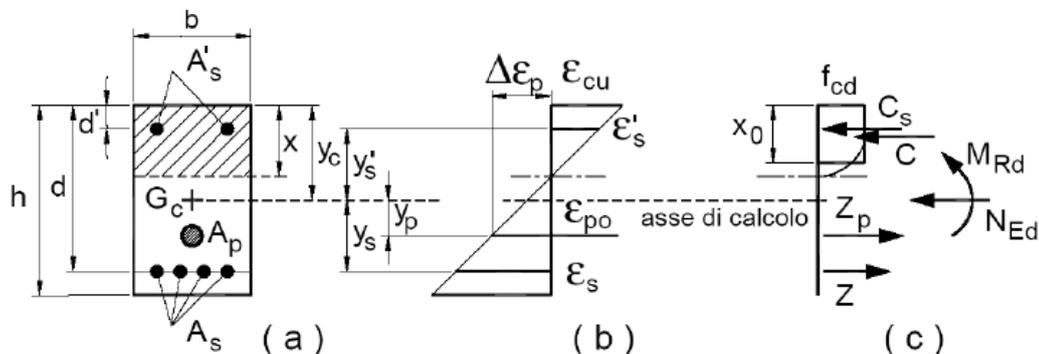
Fig. 5 – Schema per la valutazione della capacità resistente di una sezione presso-inflessa
