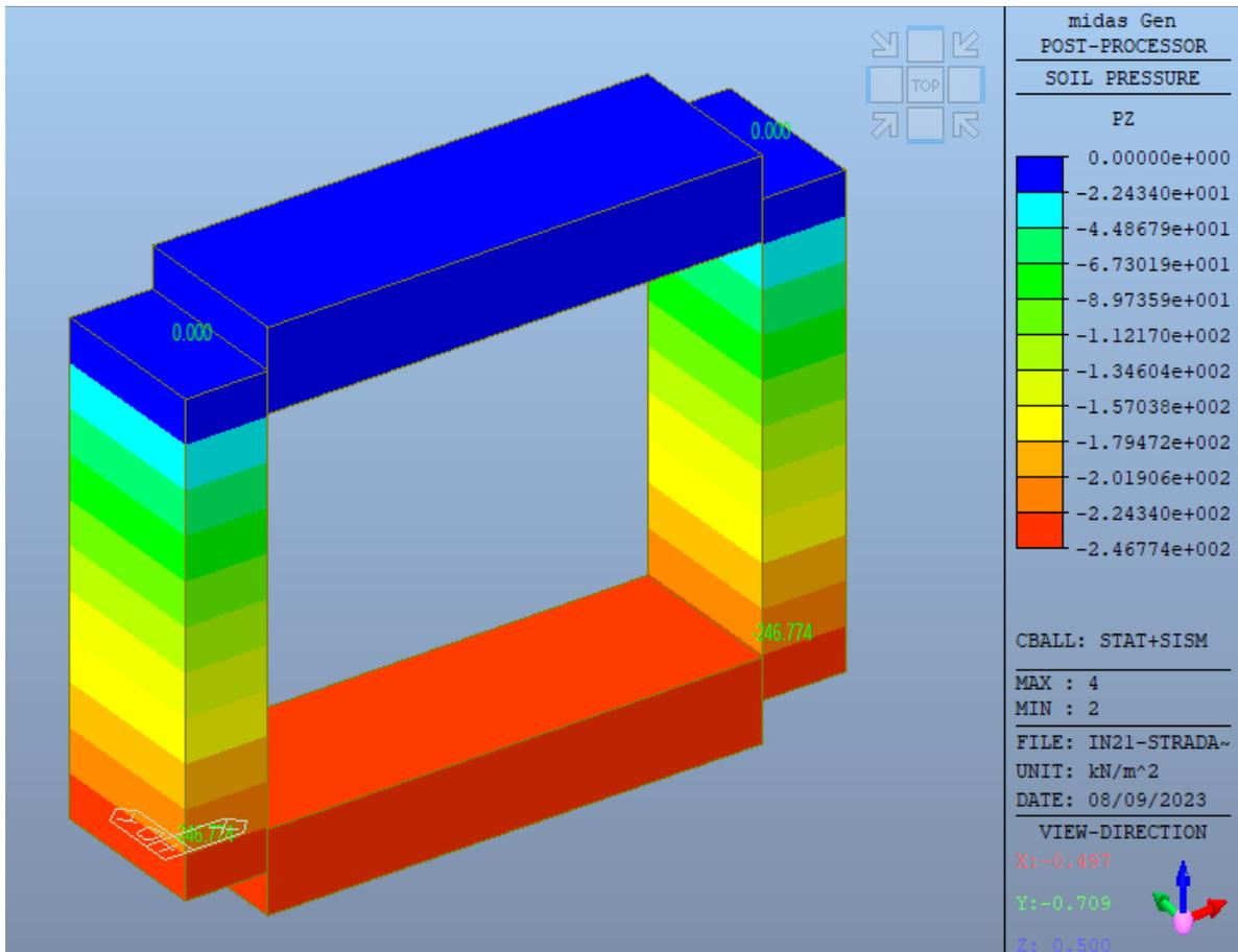
La sollecitazione risulta pari a **0.247 Mpa** e minore di quella resistente derivante dalla verifica in CD pari a **0.255 Mpa**.
