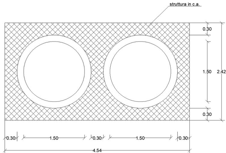
Figura 1: Sezione trasversale dell'opera
