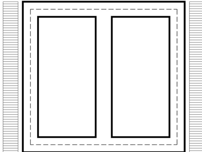
Per tenere in conto dei carichi agenti sul semispessore degli elementi considerati nel modello di calcolo, si applicano delle forze concentrate nei nodi tra piedritti e soletta superiore con valore pari a 7.33 kN ed inferiore con valore pari a 7.33 kN.
