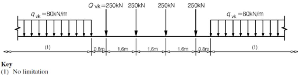
Fig. 6 – Load model 71 (al punto 6.3.2. della norma EN 1991-2:2003)
