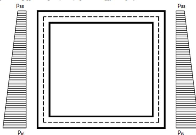
Per tenere in conto dei carichi agenti sul semispessore degli elementi considerati nel modello di calcolo, si applicano delle forze concentrate nei nodi tra piedritto e soletta superiore con valore pari a  $0.36 \text{ kN}$  ed inferiore con valore pari a  $3.07 \text{ kN}$ .
