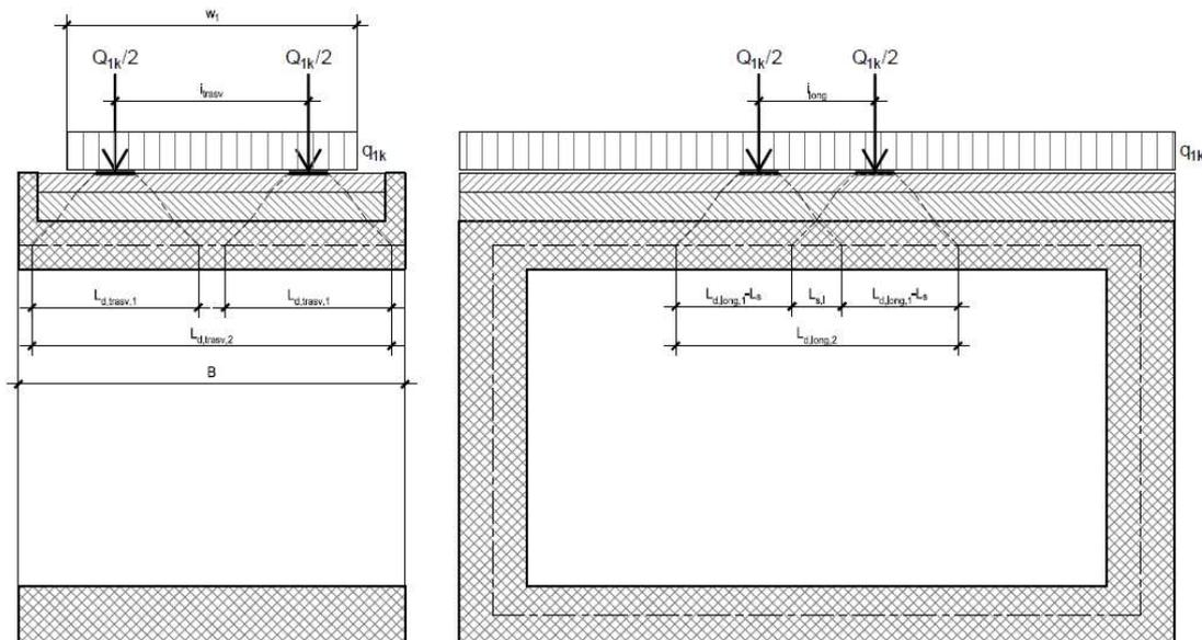
Figura 3. Diffusione in direzione trasversale e longitudinale del carico tandem.
