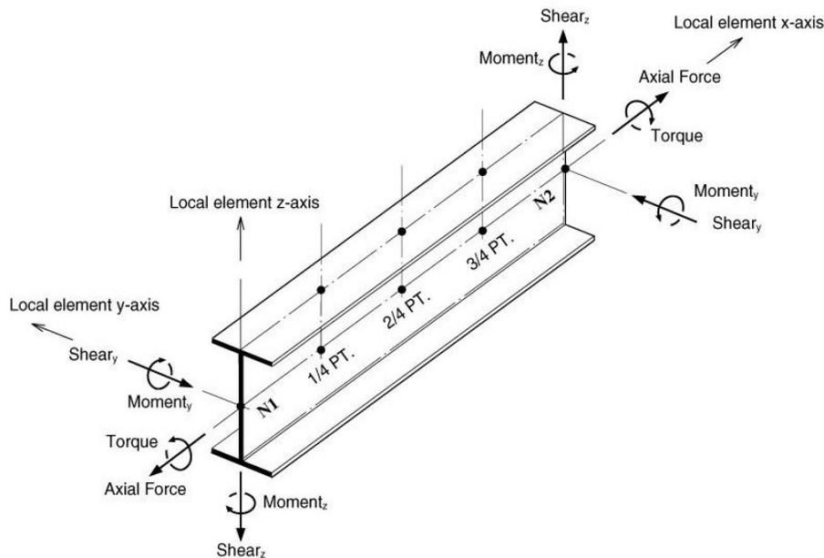
Fig. 7 - Convenzione dei segni del riferimento locale dell'elemento
