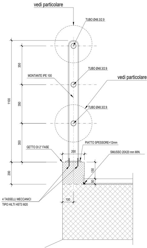
PARTICOLARE MONTANTE E PIASTRA PARAPETTO-Scala 1:5
