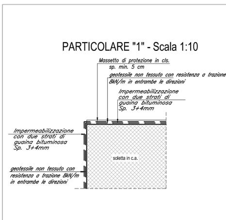
SCHEMA DI POSA IMPERMEABILIZZAZIONE - Scala 1:20
