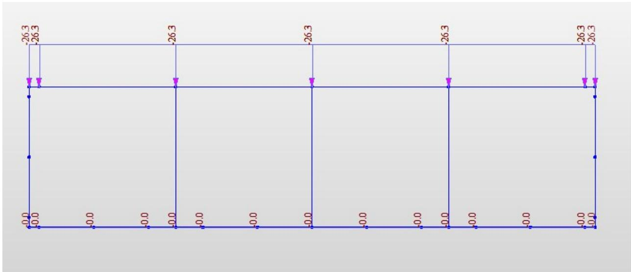
*Fig. 7 – Carichi distributi verticali permanenti (PERM)*
