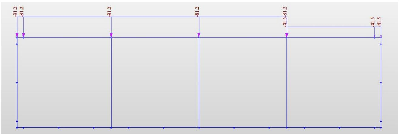
*Fig. 15 – Carico LM71; condizione per massimizzare il taglio*
