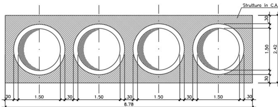
*Fig. 4 – Geometria dell'opera*
