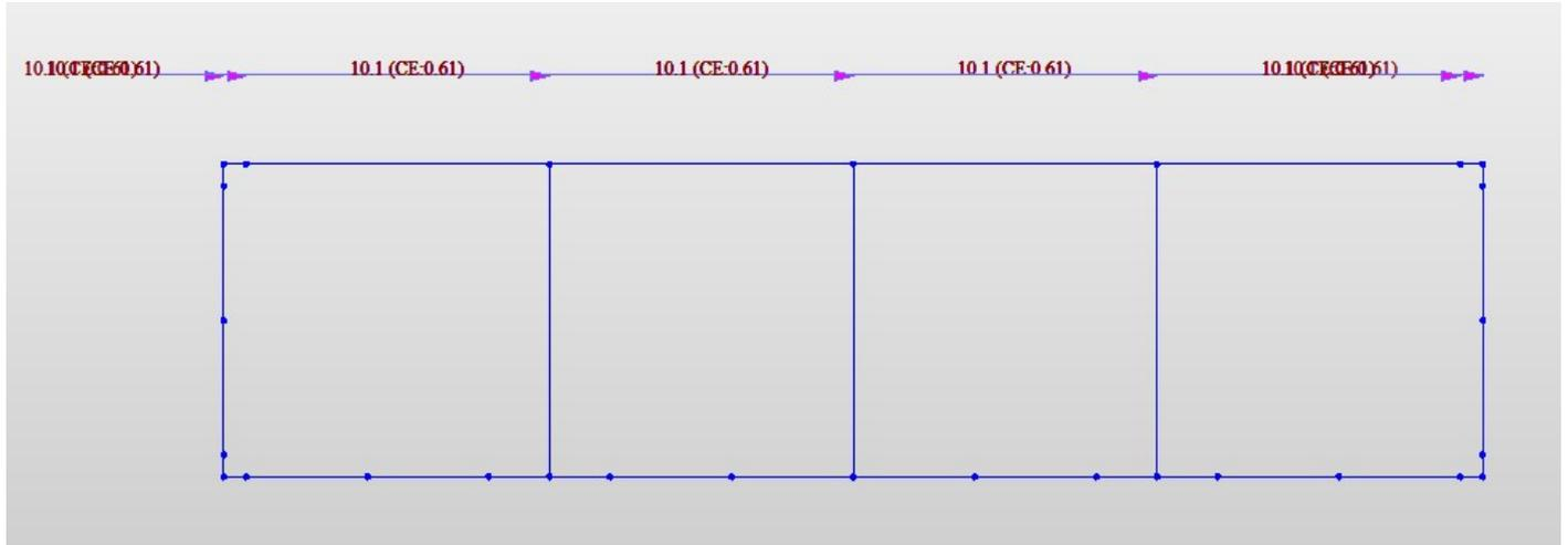
*Fig. 20 – Applicazione dell'avviamento/frenatura*
