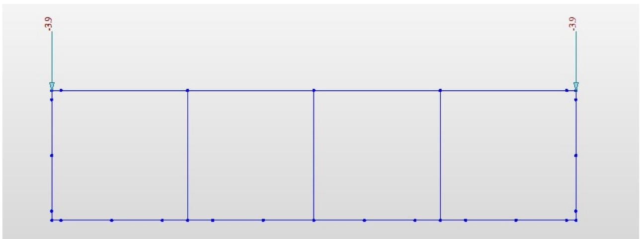
*Fig. 8 – Carichi puntuali verticali permanenti (PERM)*
