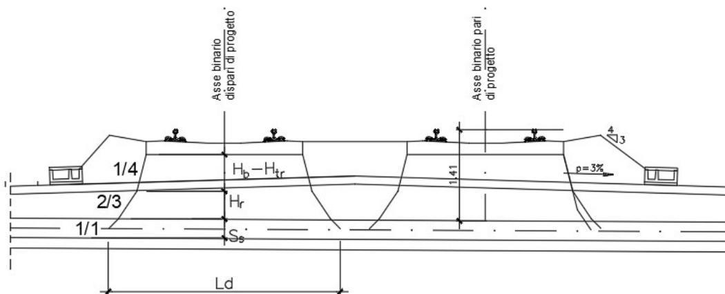
*Fig. 13 – Diffusione del carico in senso trasversale*
