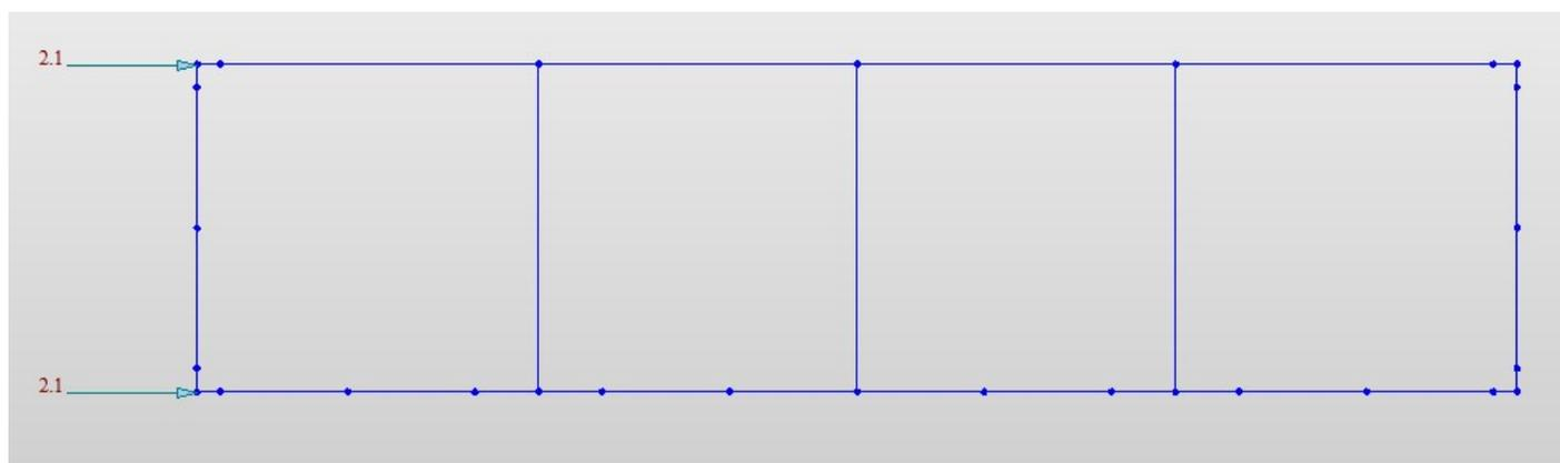
*Fig. 24 – Sovraspinta sismica concentrati nei node SISSX*
