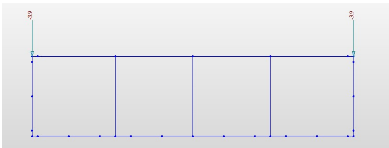
Fig. 8 – Carichi puntuali verticali permanenti (PERM)
