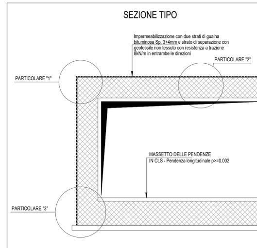
SCHEMA DI POSA IMPERMEABILIZZAZIONE - Scala 1:20
