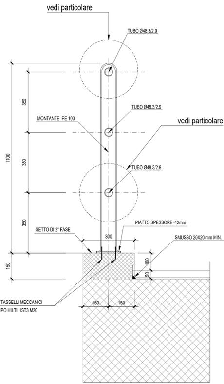
PROSPETTO PARAPETTO CORRENTE - Scala 1:10
