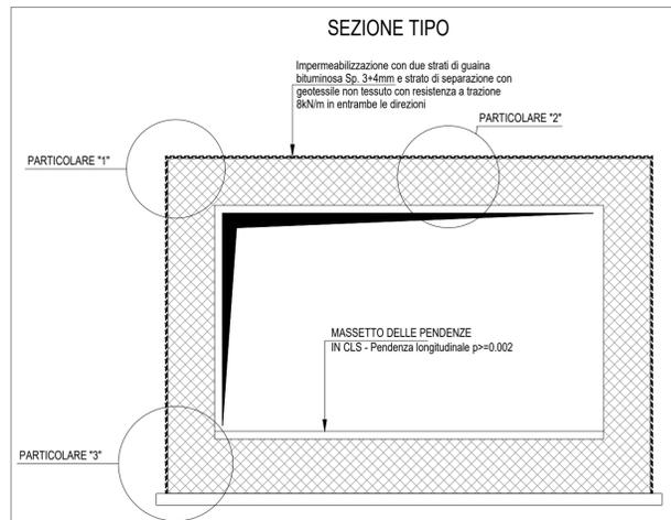
SCHEMA DI POSA IMPERMEABILIZZAZIONE - Scala 1:20
