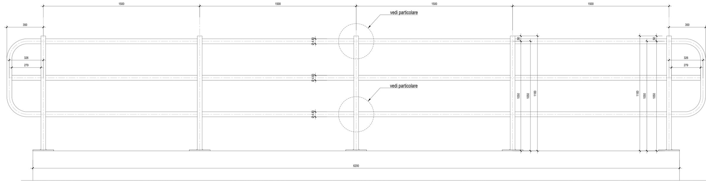
PROSPETTO PARAPETTO CORRENTE - Scala 1:10
