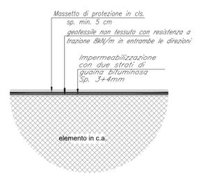
SCHEMA DI POSA IMPERMEABILIZZAZIONE - Scala 1:20
