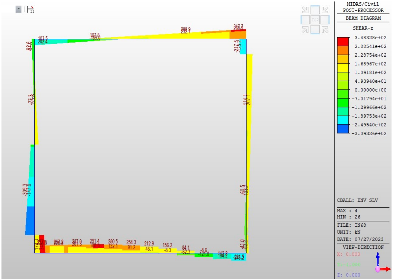
Fig. 30 – Involuppo sforzi taglianti SLV
