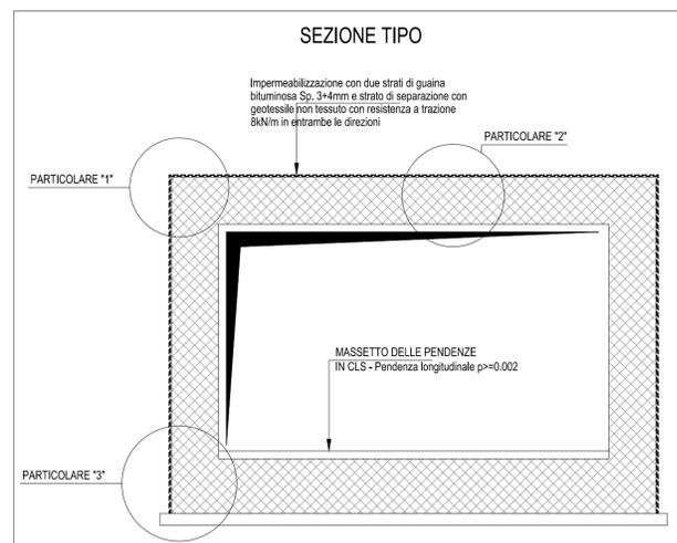
SCHEMA DI POSA IMPERMEABILIZZAZIONE - Scala 1:20
