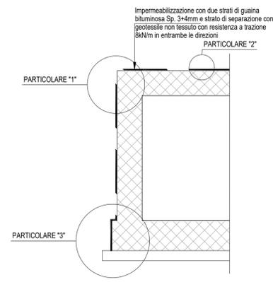
SCHEMA DI POSA IMPERMEABILIZZAZIONE - Scala 1:20 (Doppia guaina bituminosa)
