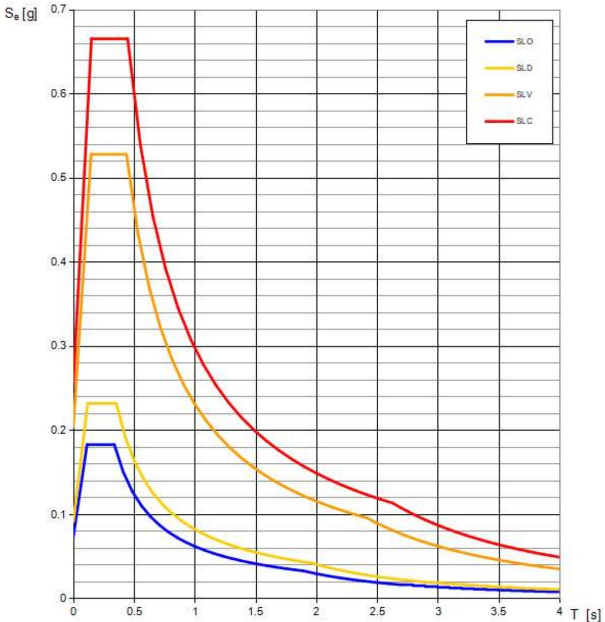
Il calcolo viene eseguito con il metodo pseudostatico. In queste condizioni l'azione sismica è rappresentata da una forza statica equivalente pari al prodotto delle forze di gravità per un opportuno coefficiente sismico.
