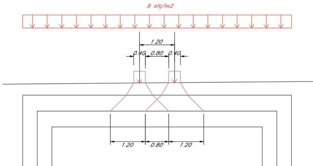
*Fig. 14 – Schema di distribuzione del carico mobile considerate ACC1*
