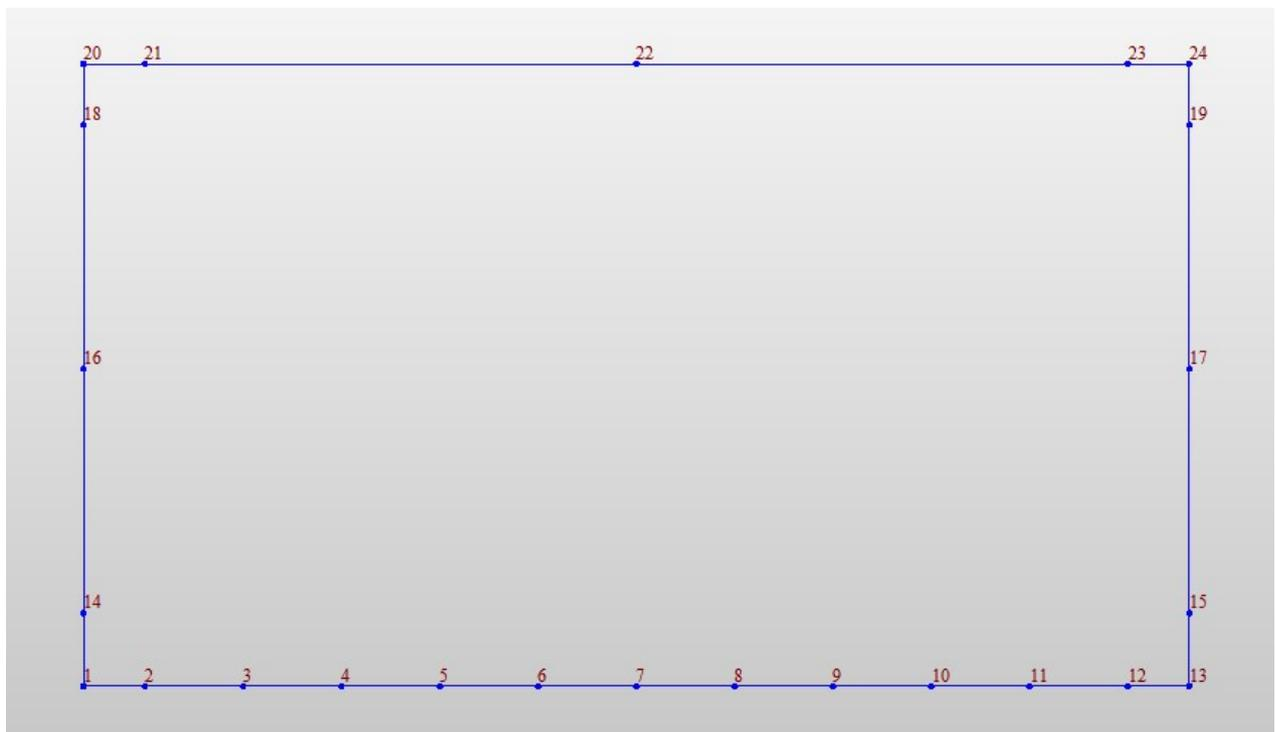
*Fig. 6 – Numerazione dei nodi nel modello strutturale*
