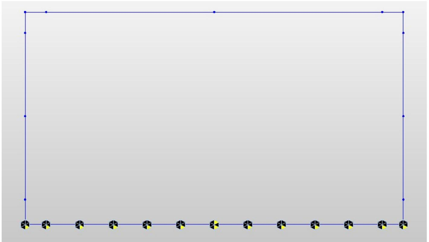
Fig. 4 – Modellazione molle elastiche in MIDAS
