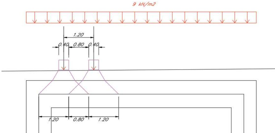
*Fig. 16 – Schema di distribuzione del carico mobile considerate ACC2*
