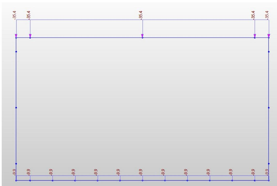
Fig. 8 – Carichi distribuiti verticali permanenti (PERM)
