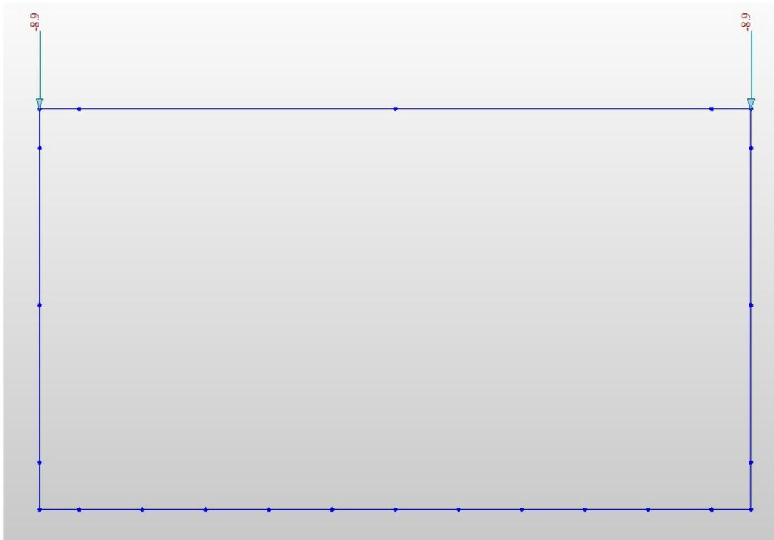
Fig. 9 – Carichi puntuali verticali permanenti (PERM)
