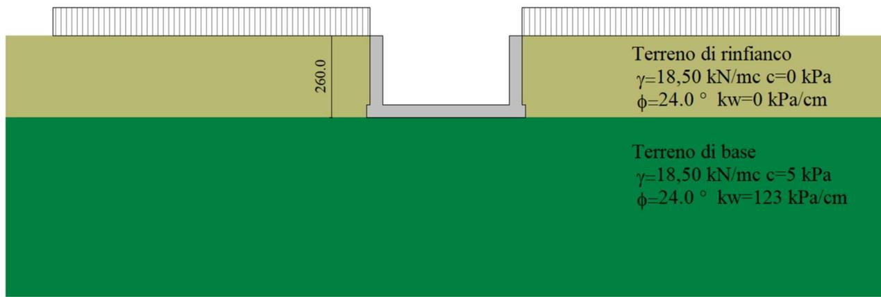
Figura 4 – Modello Geometrico Geotecnico di Riferimento – 1/2
