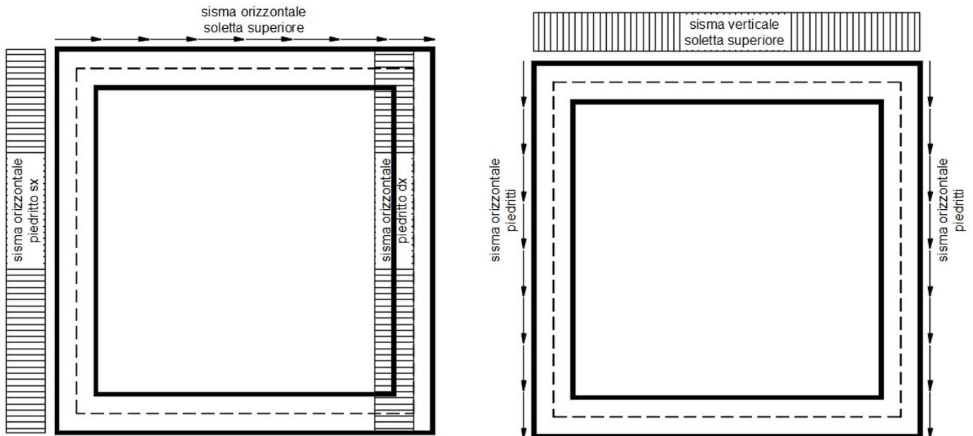
Per tenere in conto dei carichi agenti sul semispessore degli elementi considerati nel modello di calcolo, si applicano delle forze concentrate nei nodi tra piedritto e soletta superiore con valore pari a 1.28 kN ed inferiore con valore pari a 1.28 kN.
