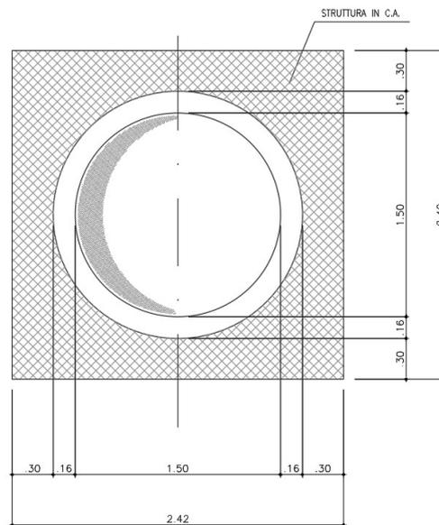
*Fig. 1 – Sezione trasversale dell'opera*
