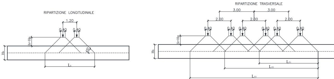
Il carico è schematizzato da due assi da 150 kN disposti ad interasse di 1.20m. Si procede al calcolo dei carichi per metro lineare riferiti al baricentro della soletta per i diversi treni di carico. Si considera una larghezza di ripartizione trasversale massima pari alla larghezza della corsia di carico di 3.00 m pertanto:
