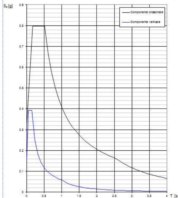
Il calcolo viene eseguito con il metodo pseudo statico, si eseguirà un calcolo elastico assumendo un fattore di struttura unitario. In queste condizioni l'azione sismica è rappresentata da una forza statica equivalente pari al prodotto delle forze di gravità per un opportuno coefficiente sismico.
