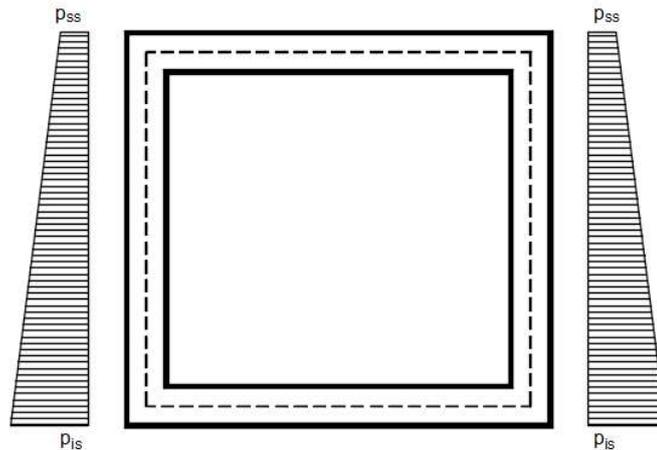
Per tenere in conto dei carichi agenti sul semispessore degli elementi considerati nel modello di calcolo, si applicano delle forze concentrate nei nodi tra piedritto e soletta superiore con valore pari a 0.26 kN ed inferiore con valore pari a 3.17 kN.
