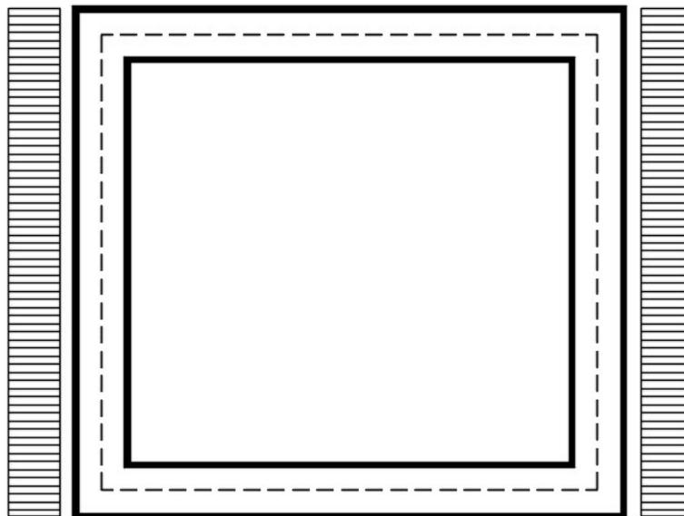
Per tenere in conto dei carichi agenti sul semispessore degli elementi considerati nel modello di calcolo, si applicano delle forze concentrate nei nodi tra piedritti e soletta superiore con valore pari a 1.28 kN ed inferiore con valore pari a 1.28 kN.
