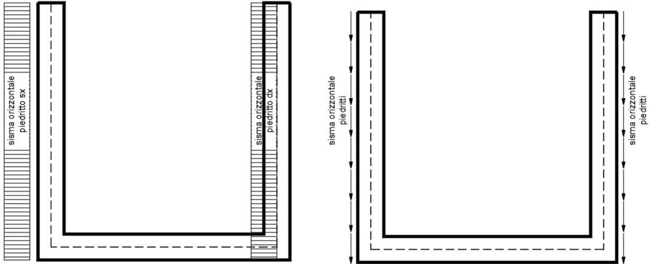
Per tenere in conto dei carichi agenti sul semispessore degli elementi considerati nel modello di calcolo, si applicano delle forze concentrate nei nodi tra piedritto e soletta inferiore con valore pari a 1.28 kN.
