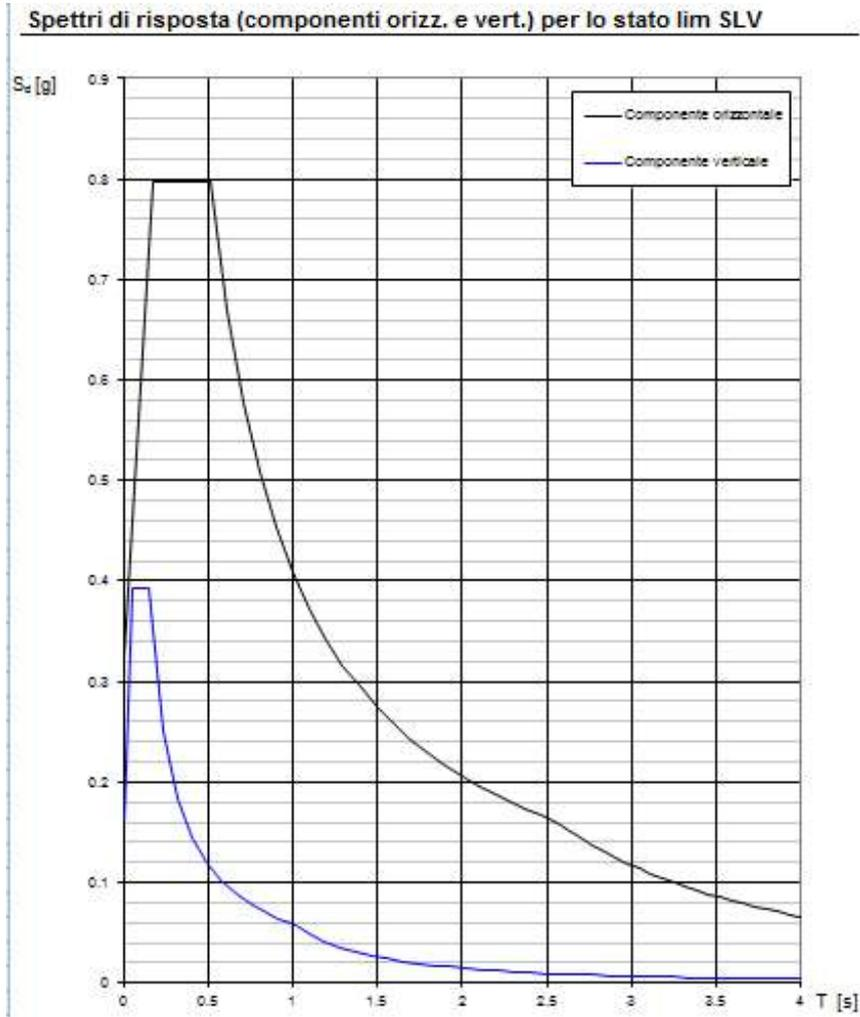
Il calcolo viene eseguito con il metodo pseudo statico, si eseguirà un calcolo elastico assumendo un fattore di struttura unitario. In queste condizioni l'azione sismica è rappresentata da una forza statica equivalente pari al prodotto delle forze di gravità per un opportuno coefficiente sismico.
