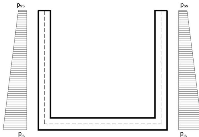
Per tenere in conto dei carichi agenti sul semispessore degli elementi considerati nel modello di calcolo, si applicano delle forze concentrate nei nodi tra piedritto e soletta inferiore con valore pari a 2.85 kN.
