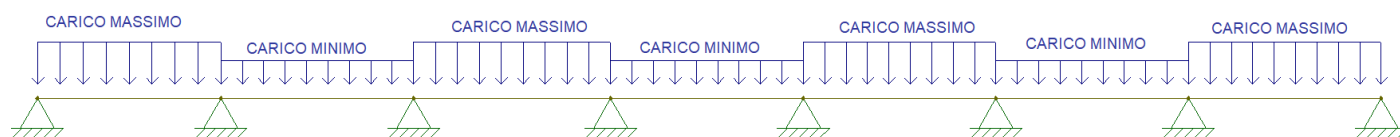
Figure 9-2 Combinazione per massimizzare il momento positivo nelle campate dispari.
