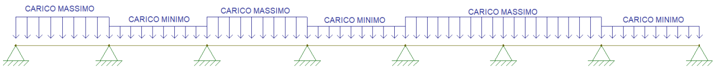
Figure 9-8 Combinazione per massimizzare il momento negativo sull'appoggio n. 6.
