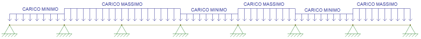
Figure 9-5 Combinazione per massimizzare il momento negativo sull'appoggio n. 3.
