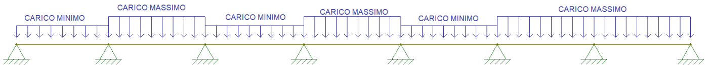
Figure 9-9 Combinazione per massimizzare il momento negativo sull'appoggio n. 7.
