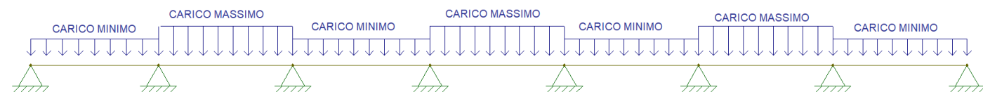
Figure 9-3 Combinazione per massimizzare il momento positivo nelle campate pari.
