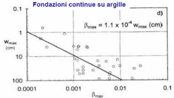
Nel caso in esame si ottiene un cedimento massimo  $W_{max}$  di 3mm e quindi un valore della massima distorsione angolare  $\beta_{max}$  minore di 0.002
