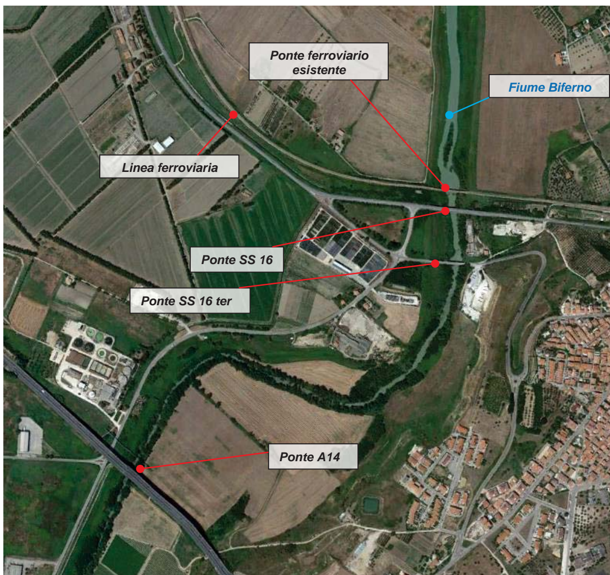
Figura 13 – Attraversamenti del Fiume Biferno
