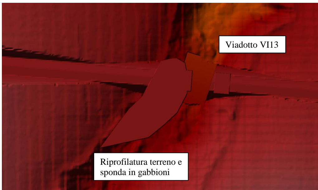
Figura 7-20. Ponte e relative spalle in alveo del canale 21+600.
