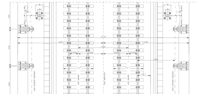
SEZIONE TIPO DI PASSAGGIO RILEVATO CON E SENZA BARRIERA
