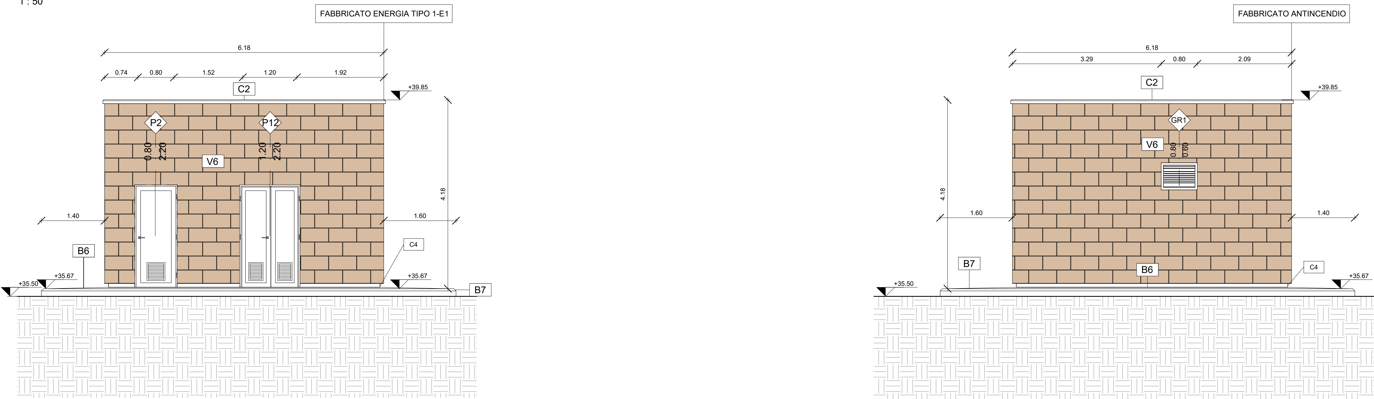
PROSPETTO AA LOCALE ENERGIA TIPO 1 1:50
