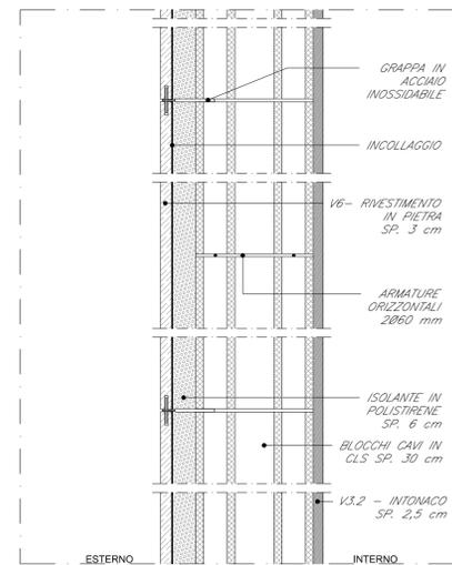
**1-PARTICOLARE SISTEMA DI FISSAGGIO**
