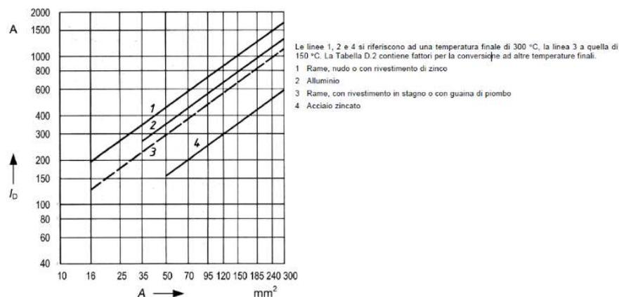
Figura 1 - Corrente permanente I<sub>D</sub> nei conduttori di terra aventi sezione A di tipo circolare.
