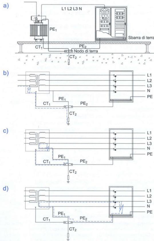
Figura 12 - Collegamenti a terra in cabina
