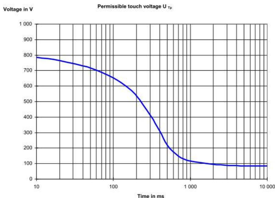
Figura 44.A.2: Massima tensione di contatto ammissibile
