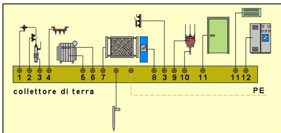
Figura 11 – Esempi di collegamenti a terra in cabina
