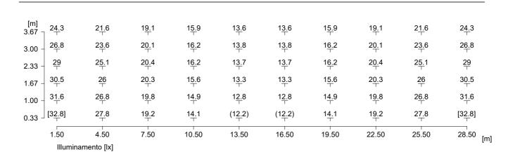
Altezza del piano di riferimento : 0.00 m Illuminamento medio : 20.6 lx Em Illuminamento minimo Emin : 12.2 lx Illuminamento massimo Emax : 32.8 lx Uniformità Uo : 1: 1.68 (0.6) min/media Uniformità Ud : 1 : 2.68 (0.37) min/max
