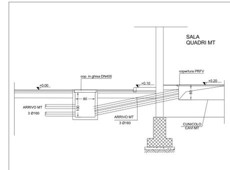
DETTAGLIO DI COLLEGAMENTO SALA QUADRI
