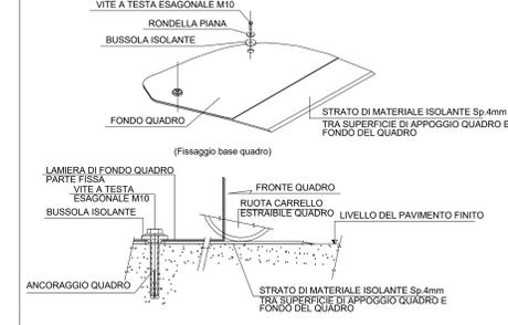
DETTAGLIO PROFILATO SOSTEGNO QUADRO ALIMENTATORI 3kVc.c.
