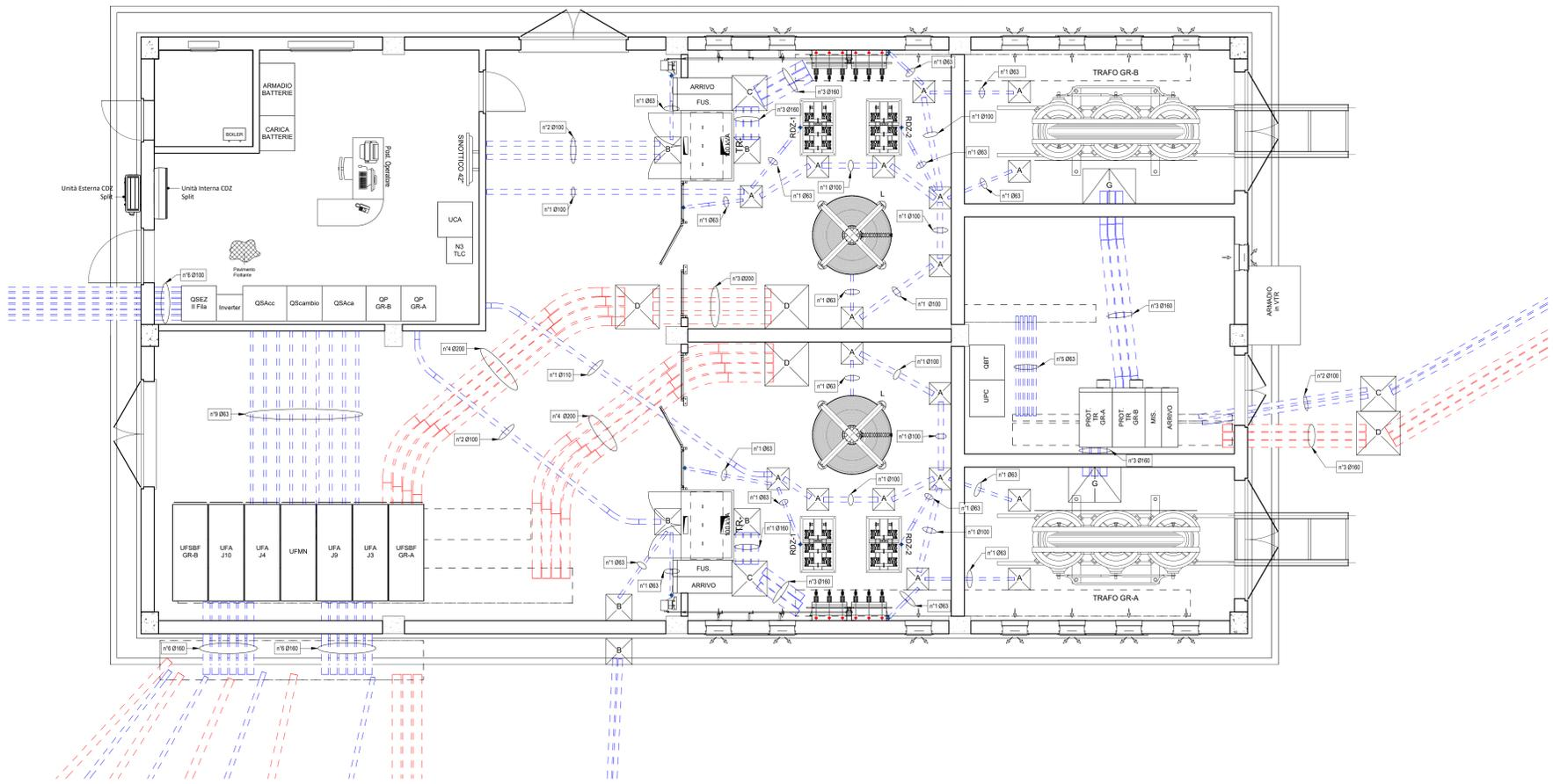
PLANIMETRIA DI DETTAGLIO - Disposizioni canalizzazioni e pozzetti
