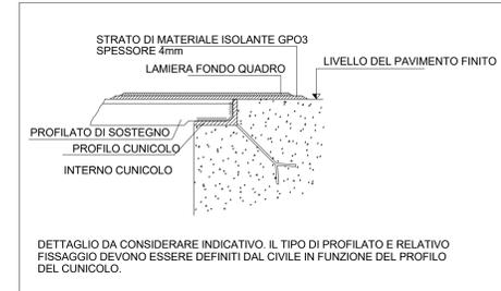
DETTAGLIO DI COLLEGAMENTO SALA QUADRI MT
